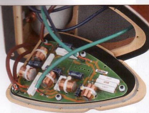
Die aufwendig gemachte Frequenzweiche sitzt auf ihrer Platine in einem eigenen Gehäuseabteil im Sockel der Box. So kann sie gut erreicht werden und ist trotzdem von der rückwärtigen Schallabstrahlung isoliert
